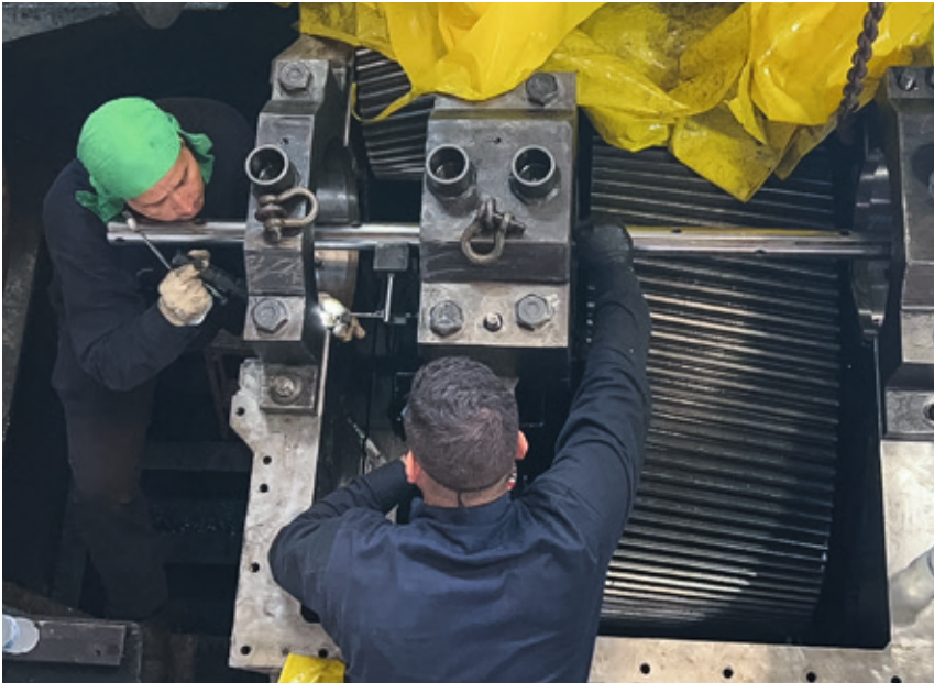
对经过返工处理的船用传动装置进行最后的找正微调。
