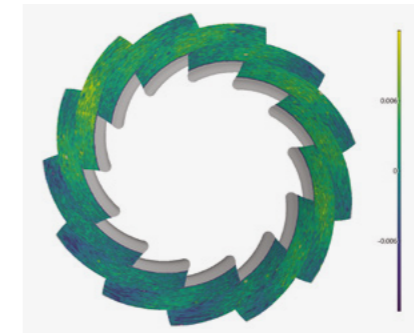
圆柱齿轮和锥齿轮的3D激光扫描。对于齿轮的逆向工程有巨大的好处。颜色显示了与取决于定义的公差带的名义数据的偏差。
