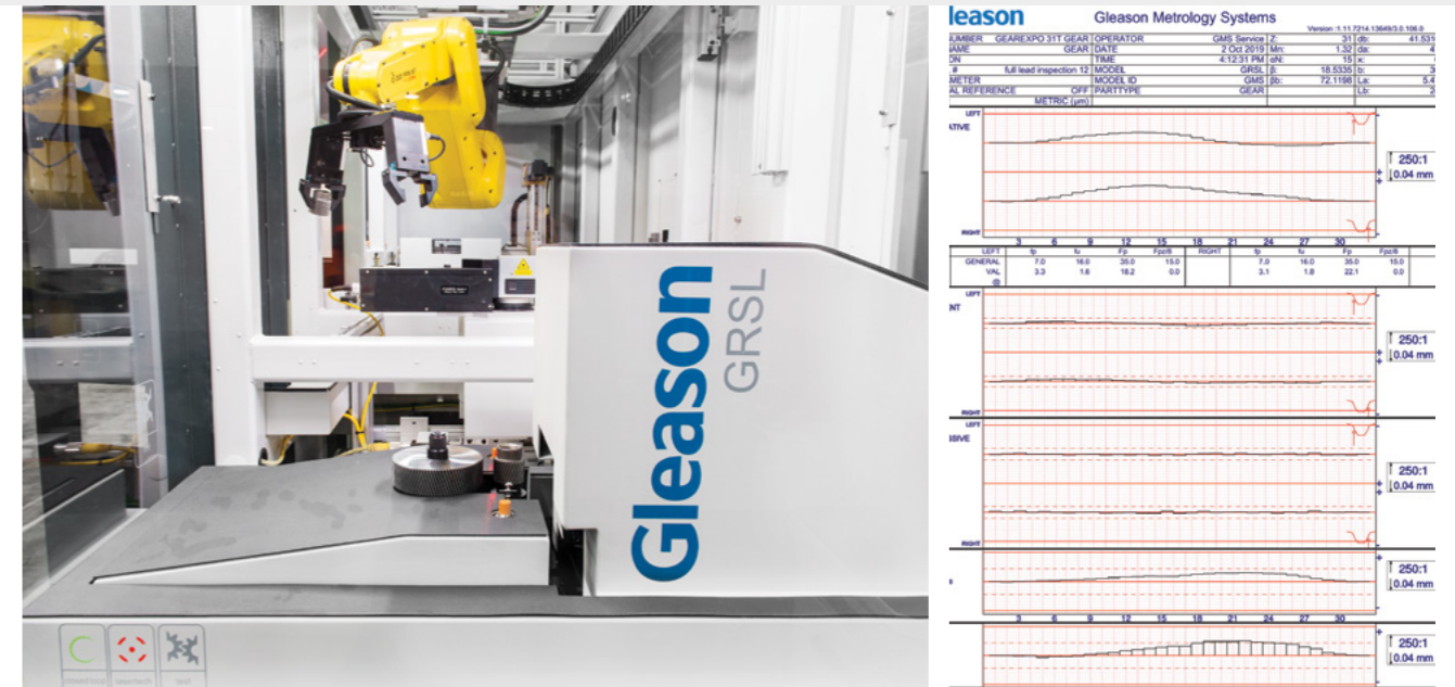
GRSL激光扫描可以100%地在几秒钟内对零件进行验证, 包括对齿形、齿向和周节测量的实时反馈和高级分析以及齿轮噪声分析。
