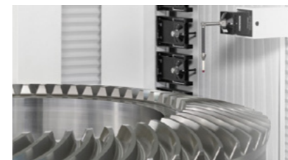
通过与格里森的GEMS® 和KISSsoft® 齿轮设计程序联网，GMS可以在锥齿轮设计时缩短大量时间并优化生产。
