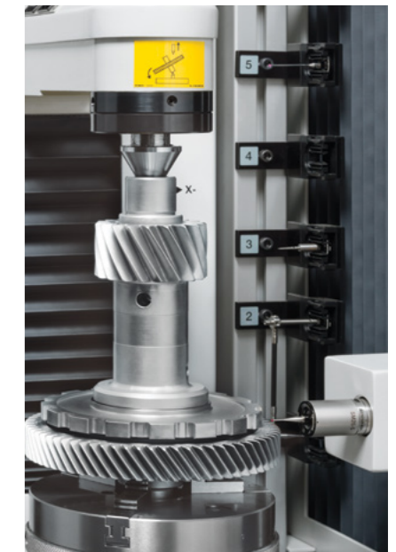
自动测头更换（APC）系统可简化操作并减少非生产时间。175GMS 4工位或6工位，300GMS 纳米 6工位或 9工位。
