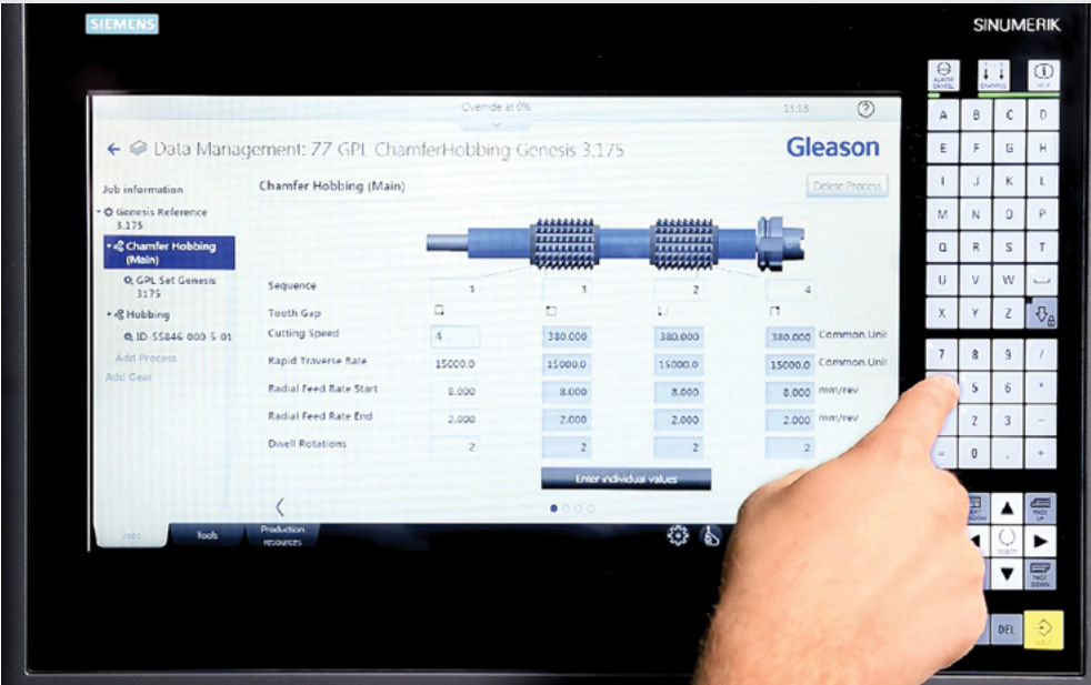
新開発のGEMS®HMIは、ホブ盤-面取盤のプロセスチェーン全体を視覚的かつ効率的に操作することが可能です。
