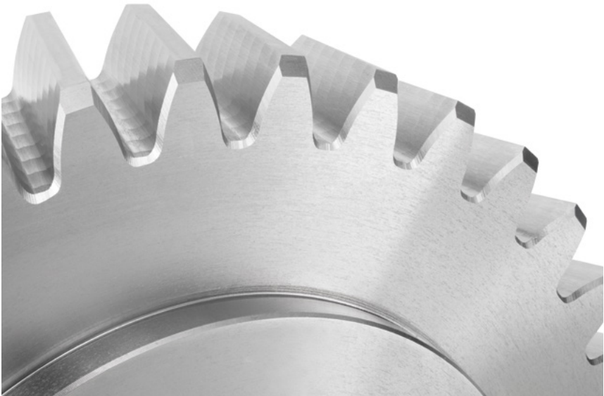
チャンファーホブで、正確で再現性が高く、バリがない面取りを実現。
