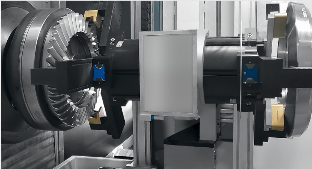
大型のギヤブランクや仕上げギヤの脱着・交換作業を自動化し、数分から22秒に短縮できます。ロボットのデュアルグリッパは、1つのグリッパで加工後のワークをロードし、旋回させて未加工ブランクをロードします。
