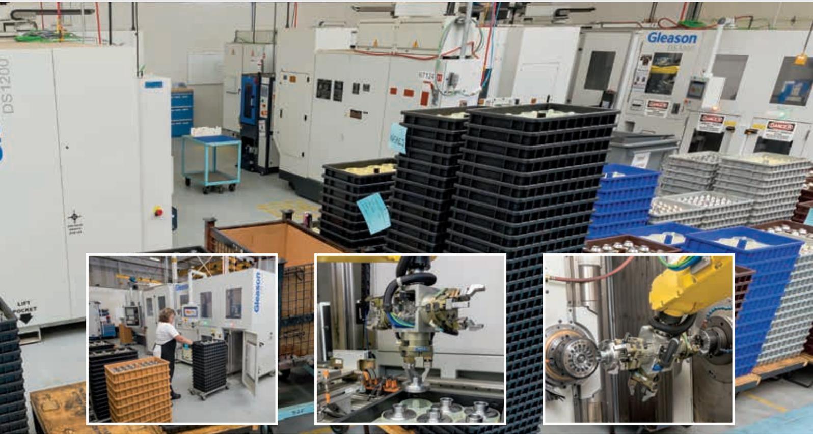
280G全台に、ローダーシステムとロボットを使用してワークのローディングを自動化するグリーソンDS1200オートローダーシステムがドッキングされています。グリーソンのオートメーションローダーは、コンベヤシステムよりも使用するフロアスペースが少なく、より多くのワークをローダー内にストックできます。
