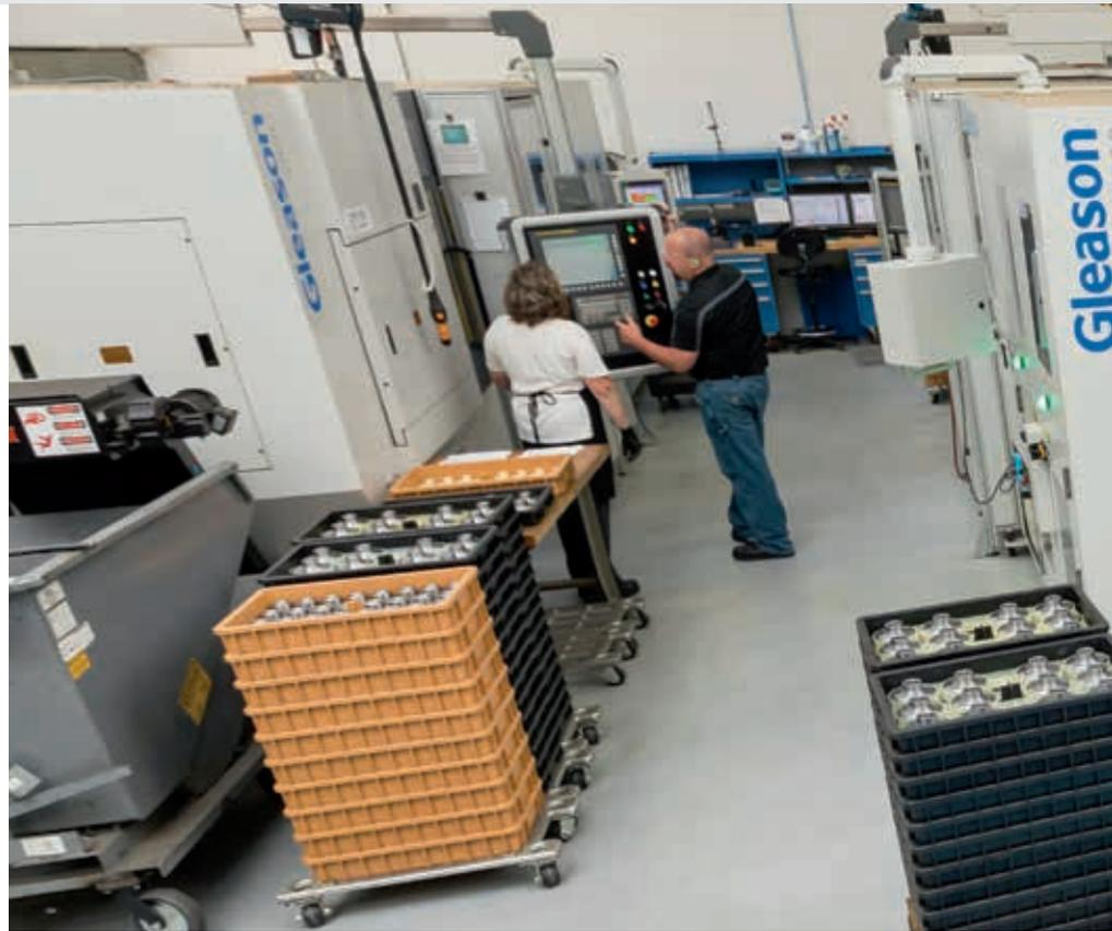
4台の280C歯切盤は現在、約40台分のメカ機の働きをしており、ワークの段取り変更時間は1シフトほどかかっていた時間を約1時間にまで短縮しています。
