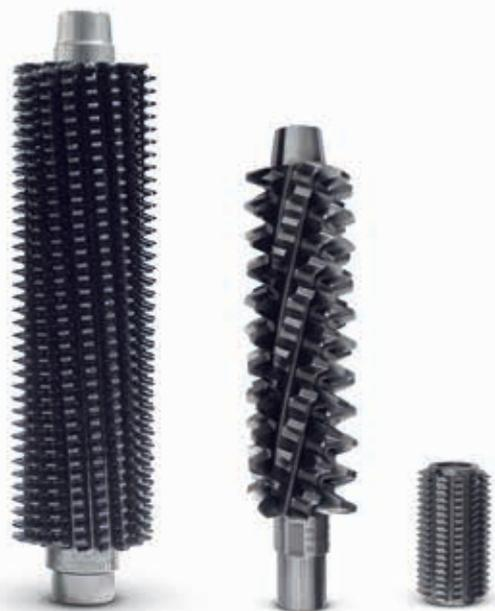
ドイツのグリーンソンカッティングツールズ社からP90G用のAlCroNite®コーティングを施した生産性の高い超硬ホブカッターを使用しています。
