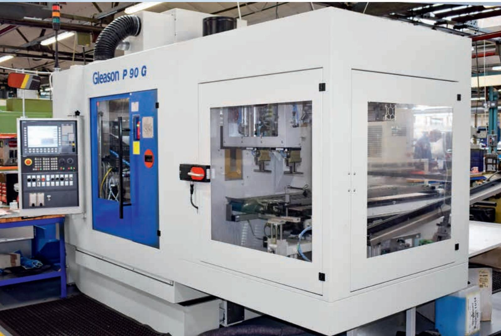
「この機械に付与されている機能と連動しており、これ以上に良い選択肢は見つかりませんでした」P90Gでは、モジュール3mmまで、外径100mmまでのスパークギヤ、ヘリカルギヤ、ピニオンのホブ加工と歯研ができます。ユーザーは3つの異なる歯研方法を使用でき、幅広い用途に対応します。
