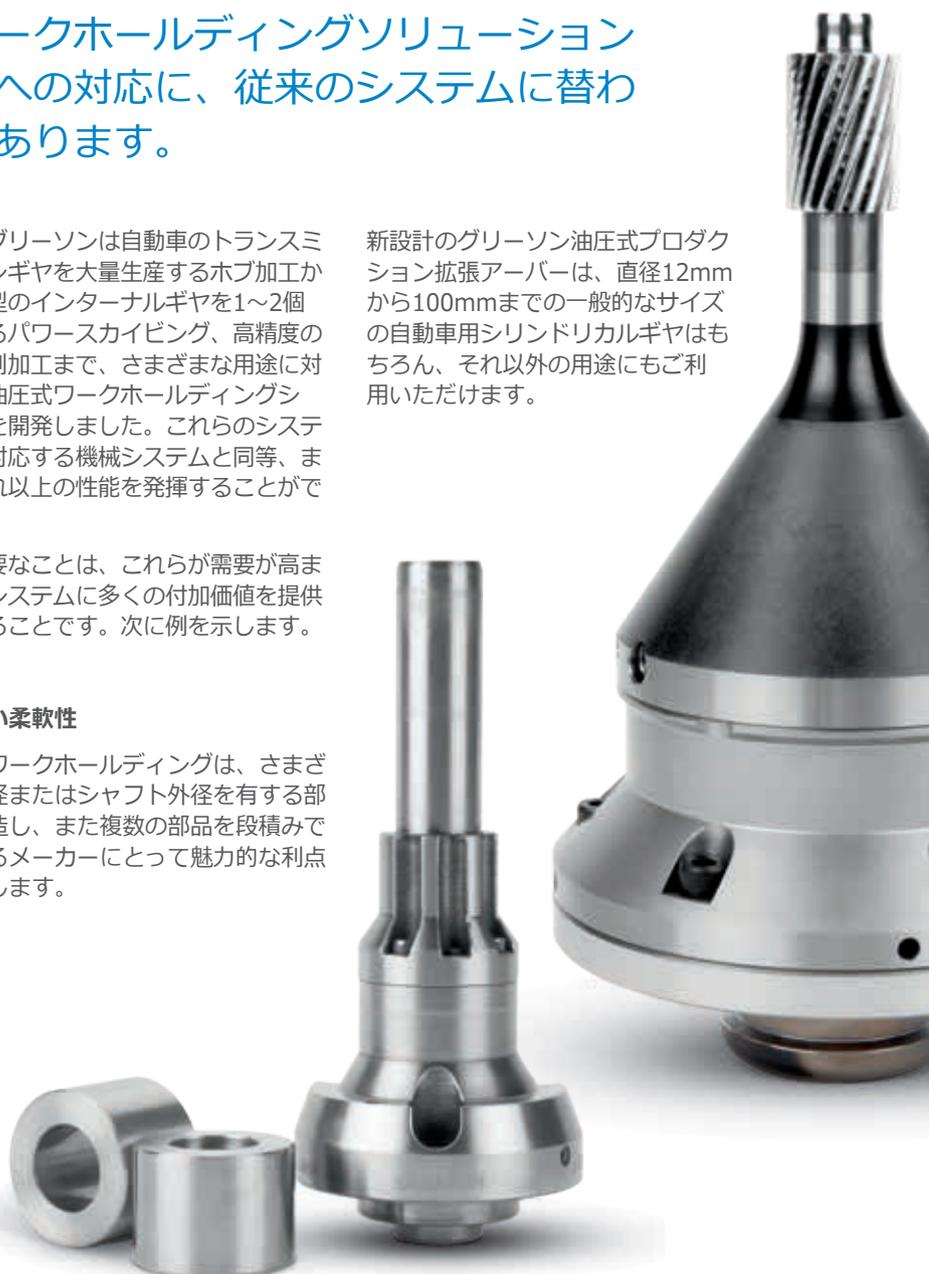
韌性の高い工具鋼を素材とする精密加工された薄肉エキスパンションスリーブに作動圧力がかかると、非常に強力で安定したクランプ力を発揮します。
