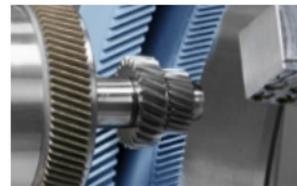
Комбинированный процесс хонингования и суперфинишной обработки
