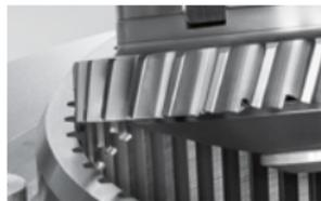
Технология Power Skiving с интегрированной функцией заточки инструмента
