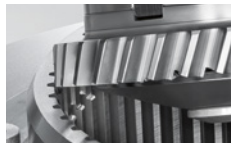
Power Skiving con affilatura integrata dell'utensile in macchina
