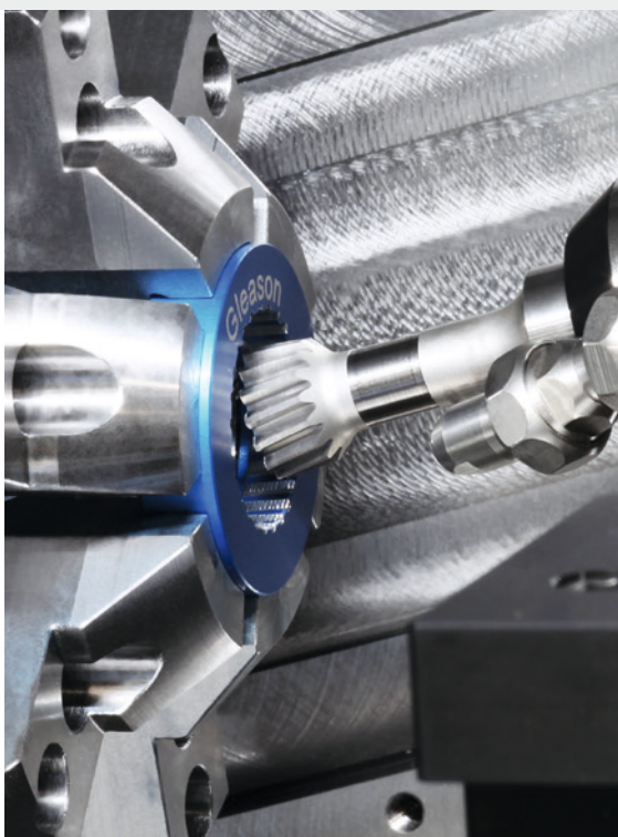
Power Skiving de Engranajes interiores.
