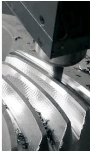
Gleason-Heller centros de Mecanizado de 5-Ejes para Engranajes Grandes Cilíndricos y Cónicos
