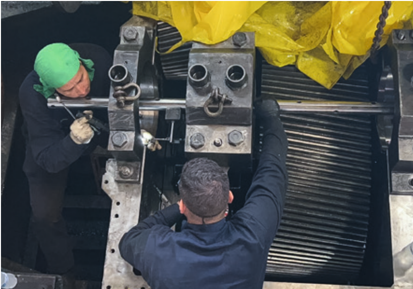
Letzte Ausrichtungsarbeiten an einem überarbeiteten Schiffsgetriebe.
