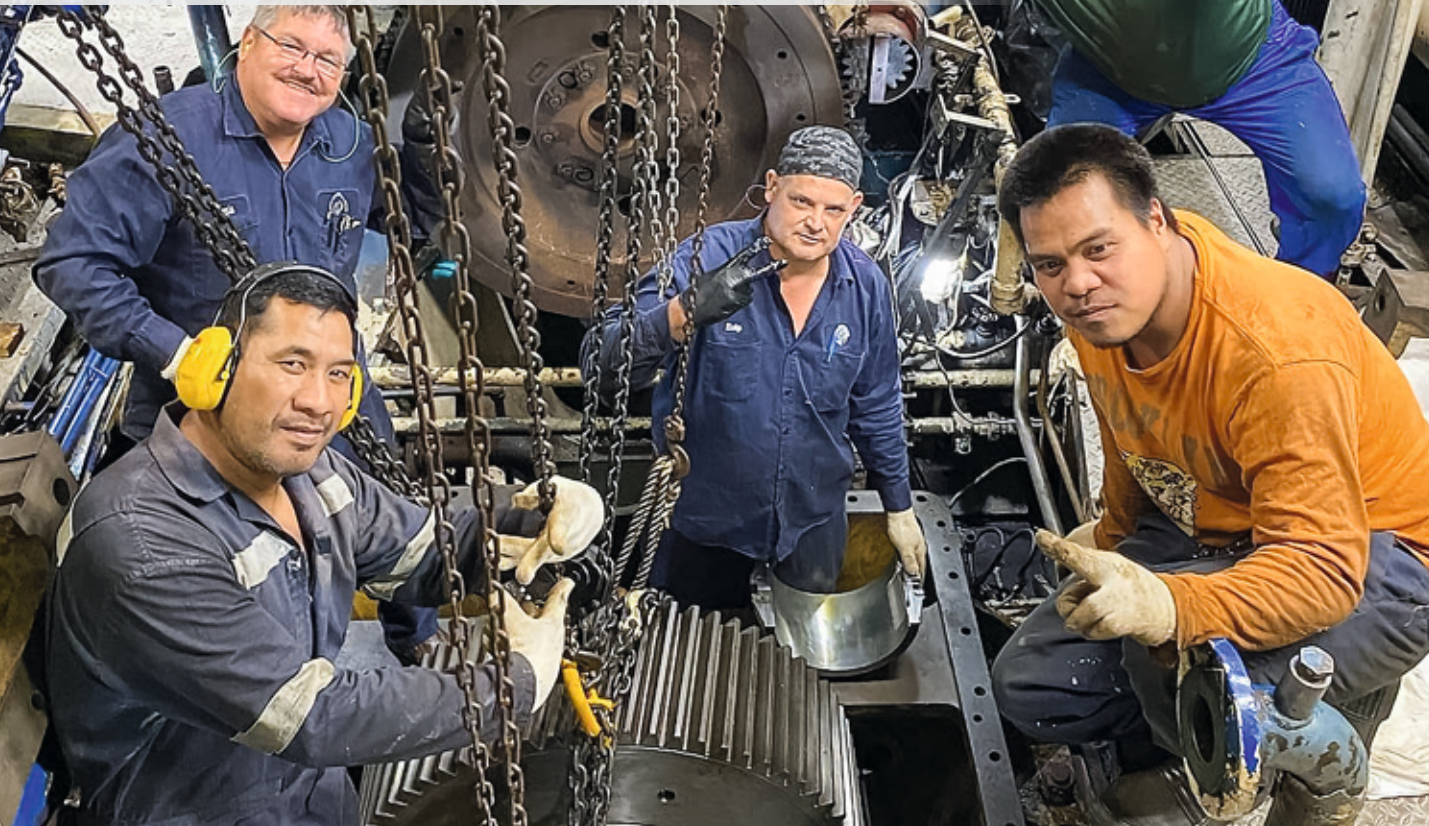
Das MIG-Team bei der Installation eines neuen Getriebes auf hoher See.
