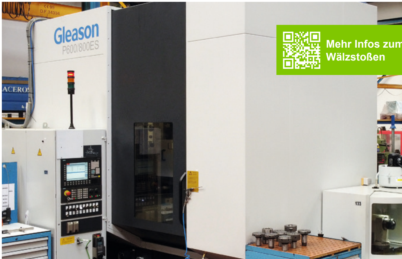
Gleason P600/800ES Wälzstoßmaschinen mit elektronischer Schrägführung für maximale Flexibilität in der Verzahnungsbearbeitung.
